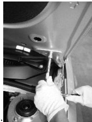
۱۰) پیچهای بین درب موتور و لولا را بندید. نیرو گشتاور بستن آن : 25N.m
