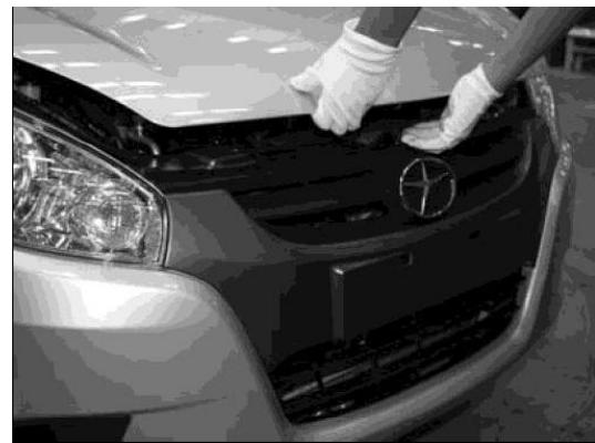
۲) پیچهای بین درب موتور و لولای آنرا شل نمایید.
